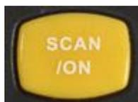
请确认电池已经安装好，电量充足，长按中间黄色开机键3秒直至设备启动。
