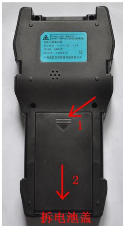
1.4.2 装入电池，确保电池顶端的触点与电池连接器充分接触，如下图所示：
