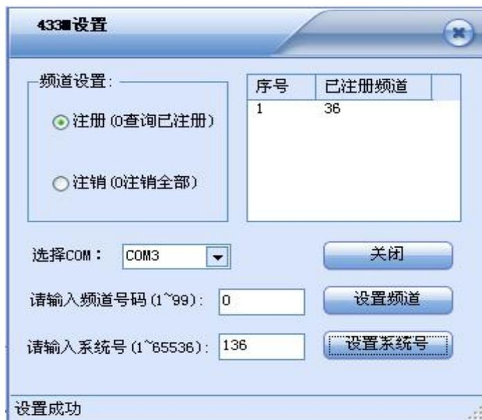
点通讯设置，进入如上对话框，选择对应的COM口号，即显示接收器已注册的频道号和系统号。
